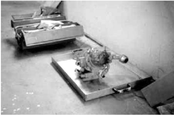
Bomba hidráulica móvil en una bandeja de goteo.
